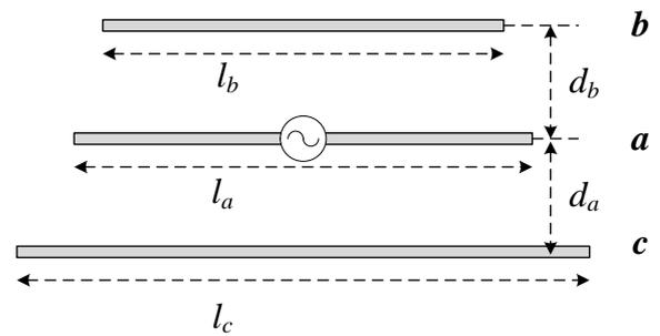
Fig. 1. Yagi-Uda antenna[4].
